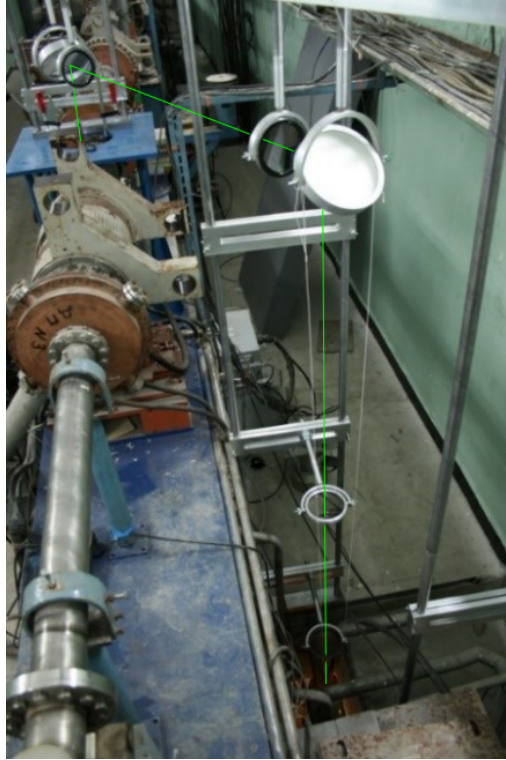
Рис. 1: Действующий зеркально-линзовый тракт на выходе ускорителя ИЯИ РАН. Зеленой линией показан ход лучей.
